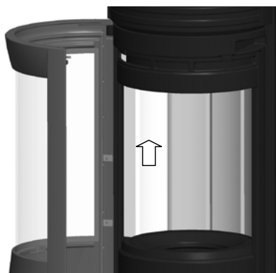
Obr. 6.3 Vyjímání vodícího kamenu
