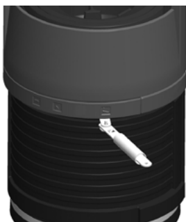
Obr. 3.8 Použití ovládací rukojeti k nastavení spalovacího vzduchu
