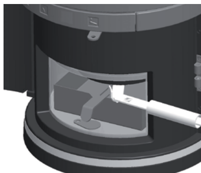
Obr. 3.5 Nátrásný rošt s ovládáním ovládací rukojetí
